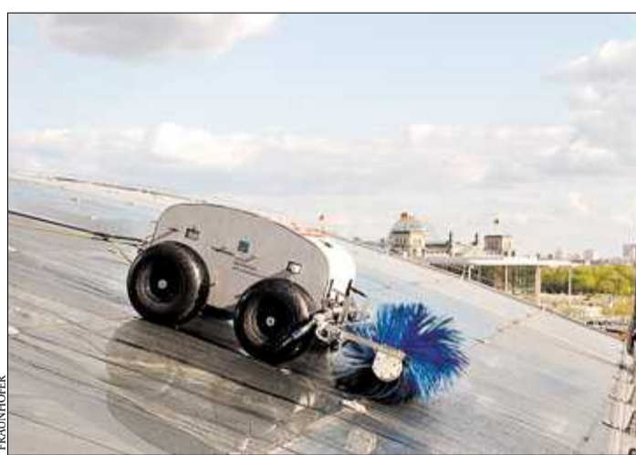
Le robot «Filius Toni». A gauche, le câble qui le tient sur le toit. Ses roues en caoutchouc surdimensionnées lui font passer les obstacles. ARCHIVES
